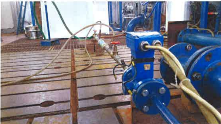
Obrázok 2. Zapojenie IPP v testovacom obvode pre stanovenie tlakových strát
