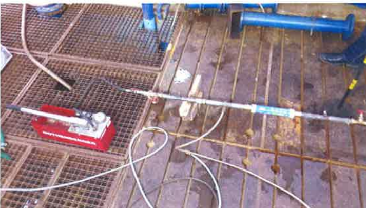
Obrázok 3. Zapojenie IPP v testovacom obvode pre skúšku tlakovej odolnosti
